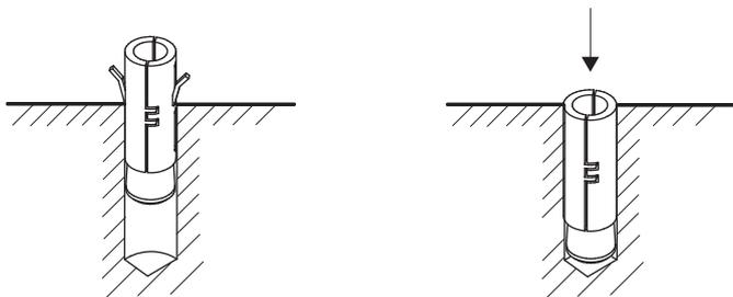
Avvitare le quattro barre filettate inox da M16 ai quattro tasselli ancoranti in acciaio per una sporgenza di 35-40 mm circa; stringere il dado inox M16 in modo tale da mettere in tiro il tassello e aderire rigidamente al foro, ottenendo una sporgenza della barra filettata di massimo 45 mm circa dal pavimento.
