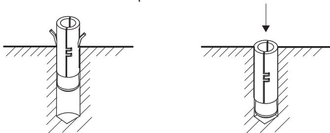
Atornillar las cuatro barras enroscadas M16 en acero inox en los cuatro tacos de anclaje en acero, de manera tal que sobresalgan en unos 35-40 mm aproximadamente; apretar la tuerca M16 en acero inox para tensar el taco de manera tal que se adhiera rigidamente al agujero, logrando que la barra enroscada sobresalga en relación con el pavimento en unos 45 mm como máximo. Desatornillar y quitar la tuerca M16 en acero inox. Repetir esta operación para todas las cuatro barras enroscadas en acero inox.
