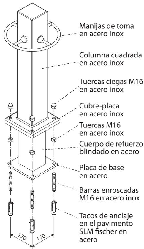
Introducir la placa de base con el cuerpo de refuerzo blindado en las cuatro barras enroscadas sobresalientes en acero inox; a continuación, atornillar y apretar a fondo las cuatro tuercas normales M16 en acero inox.
