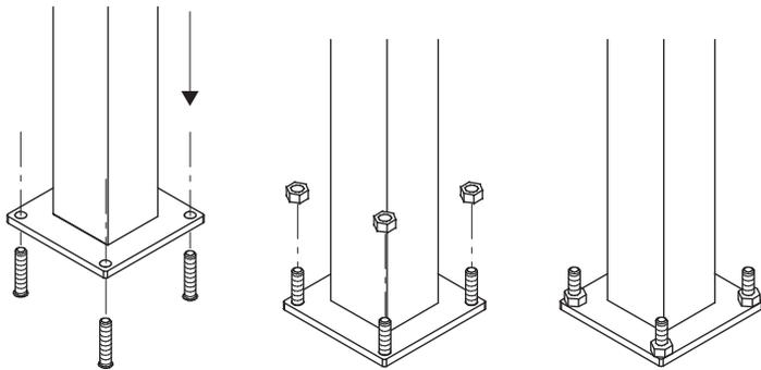
Der viereckige Edelstahl-Absperrpoller auf den geblinderten Verstärkungskörper mittels des runden Griffes montieren; die vier Edelstahl-Blindmutter M16 stark anziehen.
