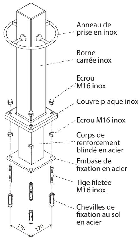
Introduire l'embase de fixation avec le corps de renforcement blindé dans les quatre tiges filetées inox. Puis serrer bien les quatre écrous M16 inox.
