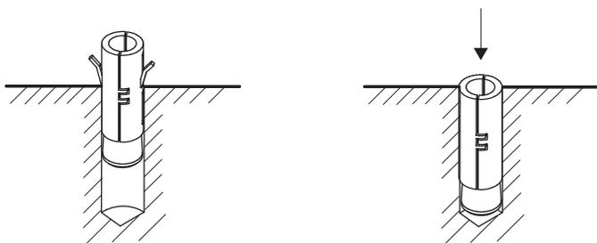
Visser les quatre tiges filetées inox M16 aux 4 chevilles de fixation en acier pour une saillie d'environ 35 - 40 mm; serrer l'écrou inox M16 pour régler la cheville qui doit bien adhérer au trou; il faut obtenir une saillie des tiges filetées de 45 mm maximum du sol.
