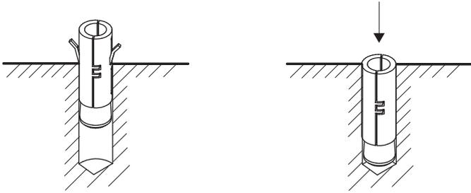
die vier geschnittenen M16 Edelstahlstifte in die vier Stahldübel verschrauben und ein Hervorstehen von 35-40 mm lassen; die Edelstahl-Mutter M16 anziehen, um den Dübel auszuspannen und im Bohrloch zu befestigen, ein Hervorstehen von höchstens 45 mm vom Boden lassen.
