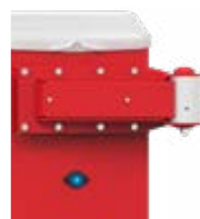
9897L ALA.180 úchyt ramene, který umožňuje horizontální otevření (rotaci) hliníkového ramene v případě nárazu vozidla a byl vyvinut za účelem ochrany hlavních strukturálních prvků hydraulické dopravní závory BAYT 980 i samotného ramene. Zařízení se dá nainstalovat na již provedené instalace závory BAYT 980, případně se dodává již namontované. Použití: maximální délka ramene 6.400 mm bez záclonek nebo 4.200 mm se záclonkami
